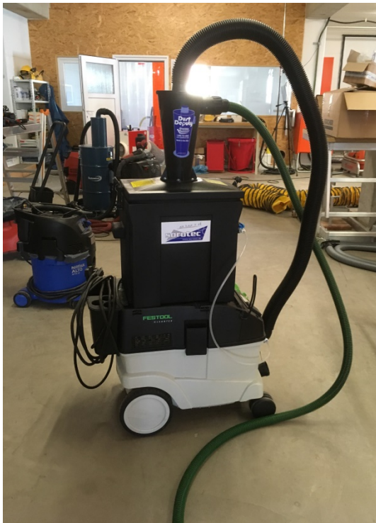
Abbildung 3: Entstauber mit aufgesetztem und separatem Vorabscheider
