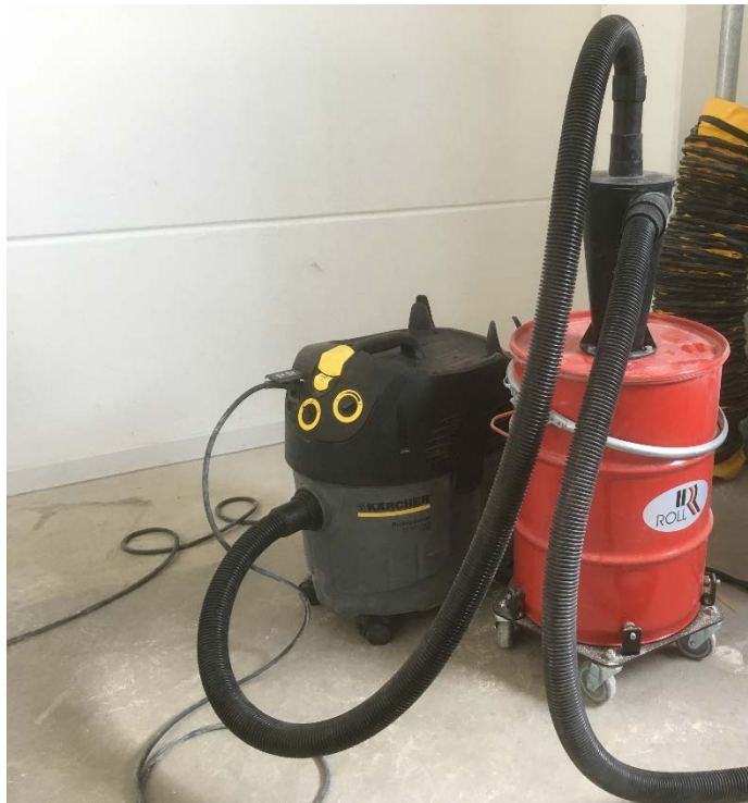
Abbildung 3: Entstauber mit aufgesetztem und separatem Vorabscheider
